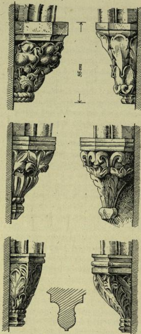
Abb. 243. Gewölbekragsteine im ehemaligen Auditorium des Domklosters (Ostflügel).
