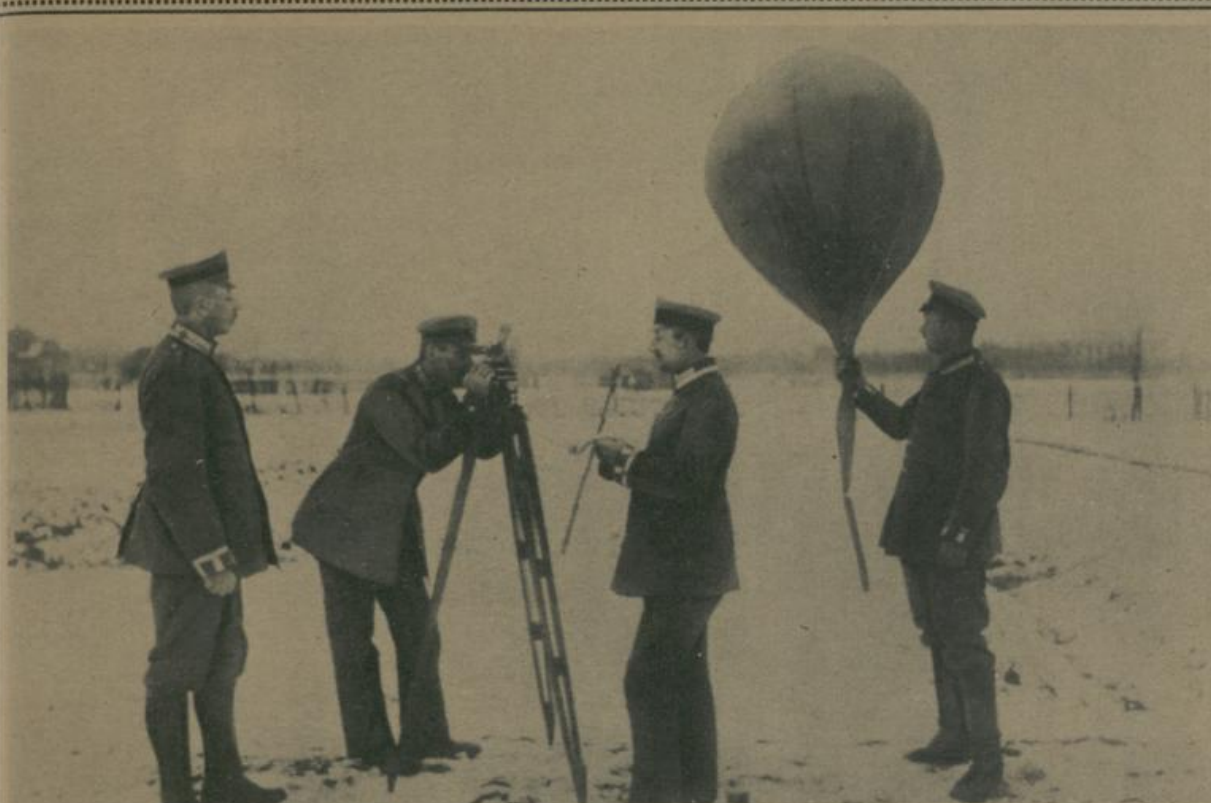
דאס ווינדמעסטען דורך אפילאטיבאלאן און טהעאדאליטען איף א דייטשע פעלדוועטערסטאציאן אויס'ן מזרח קריגסשויפלאץ. Windmessung mittels Pilot-Ballons und Theodoliten auf einer deutschen Feldwetterstation auf dem östlichen Kriegsschauplatz.
