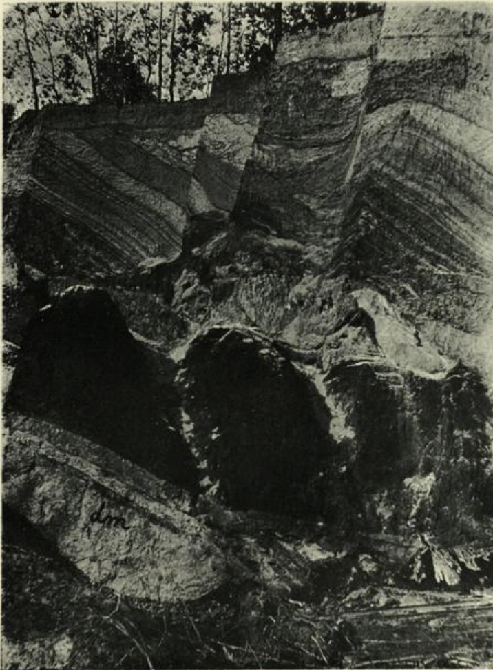
Figur 22. Aufgepreßter Älterer Geschiebemergel unter tertiären Letten und Sanden (Grube Saarow).
