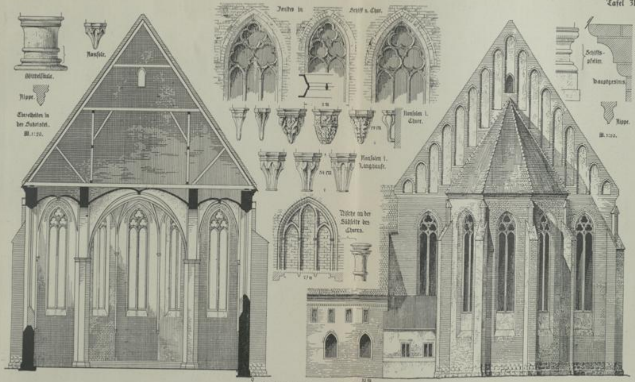
Prenzlau. Dominikanerkirche Ostseite, Querschnitt und Einzelheiten.
