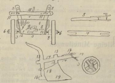
Der alte Ploch bebestand aus zwei Hauptteilen: dem Bußbloch, der Ploch pusse, Busse mit den Rädern und dem Hinterploch.
