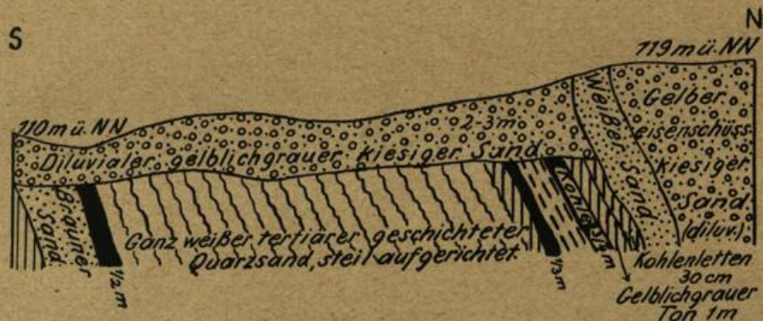
Profil 9. Aus der Störungszone des unteren Flözes. Ausbaggerung der Kohlenbahn von der Grube Marianne bei Klein-Leipisch nach der Brikettfabrik Marianne (an der Kreuzung der bisherigen Straße von Grünwalde nach Bockwitz). Maßstab 1:500 bei doppelter Ueberhöhung.
