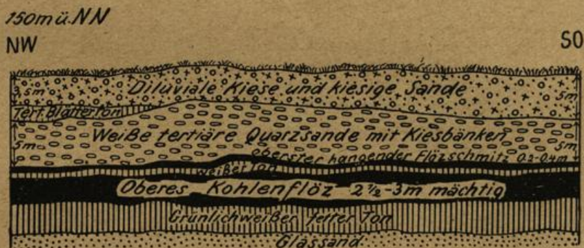
Profil 4. Aufschluß der Tongrube der Ziegelei Wischgrund, den tertiären Blätterton im Hangenden und das obere Braunkohlenflöz zeigend (Maßstab 1:1250 in doppelter Ueberhöhung).
